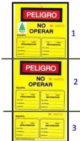
El rotulado de seguridad es una alternativa al bloqueo para aquellas máquinas que nunca se instaló un dispositivo bloqueable. En este caso la máquina se desactiva y se coloca un carné para advertir que no arranque la máquina mientras el portador del carné está trabajando dentro de ella.
